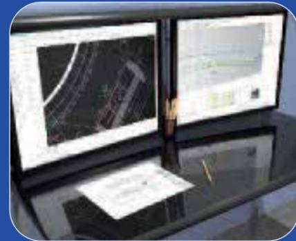
Für die Fertigung übernehmen wir Ihre CAD-Daten in den Formaten: \*.iges, \*.step, \*.sldprt (SolidWorks), \*.dwg sowie \*.dxf. Die Bearbeitungsdaten werden an unserem CAM System erstellt.
